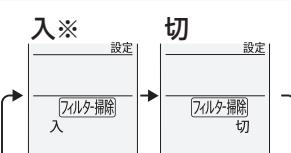
フィルター掃除自動運転の設定を「切」にしている場合、運転を10回繰り返した停止後は、エアコンを効率よくお使いいただくために、自動でフィルター掃除運転をします。
