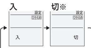
**「電力ひかえめ 入」** (設定時：運転中、リモコン画面に「ひかえめ」が表示されます)
