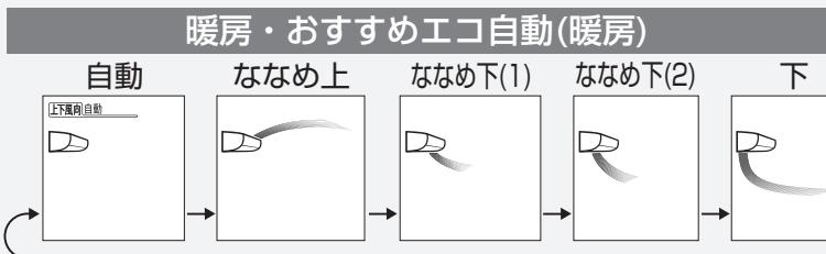
※気流パネルはななめ下方向で、パワー集中ガイドがスイングします。
