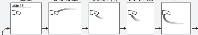
※気流パネルはななめ下方向で、パワー集中ガイドがスイングします。
