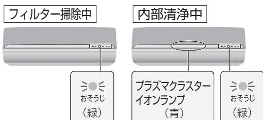
「フィルター掃除」、「内部清浄」は、停止中に手動で運転できます。自動運転よりも、念入りな運転をしますので、長期間使わないとお手入れなどに使用してください。
