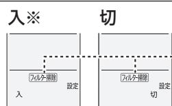
フィルター掃除自動運転の設定を「切」にしていても、エアコンを効率よくお使いいただくために、運転を10回くり返した停止後は、自動でフィルター掃除運転をします。
