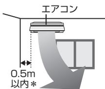
暖房時の上下風向「下」(“風ストレスをセーブ”する新気流)の風向きを変えることができます。
