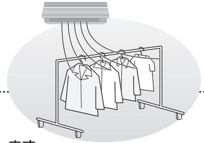
プラズマクラスターイオンで、衣類に付着したタバコ等の嫌なニオイを軽減します。衣類に風がよくあたるように、風量・風向を以下の種類の中で調節してください。
