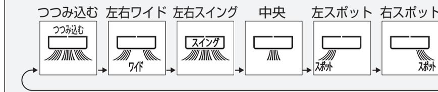
● 冷房時、冷風感を求めたい場合は、「中央」「左スポット」「右スポット」などで、人のいる方向に風向を設定してください。
