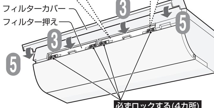
5 「フィルターカバー」の左右両端を「カチッ」と音がするまで、確実に閉じる。
