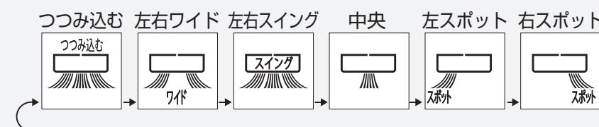
●冷房時、冷風感を求める場合は、「中央」「左スポット」「右スポット」などで、人のいる方向に風向を設定してください。
