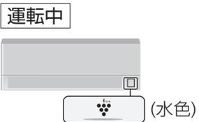
停止中にカビが増殖しやすい条件になると、ルーバーを閉じたままエアコン内部の空気を循環させます。ファンを通常とは逆に回転させて、プラズマクラスターイオンを効率よく発生させることで、エアコン内部へのカビの増殖を抑制します。
